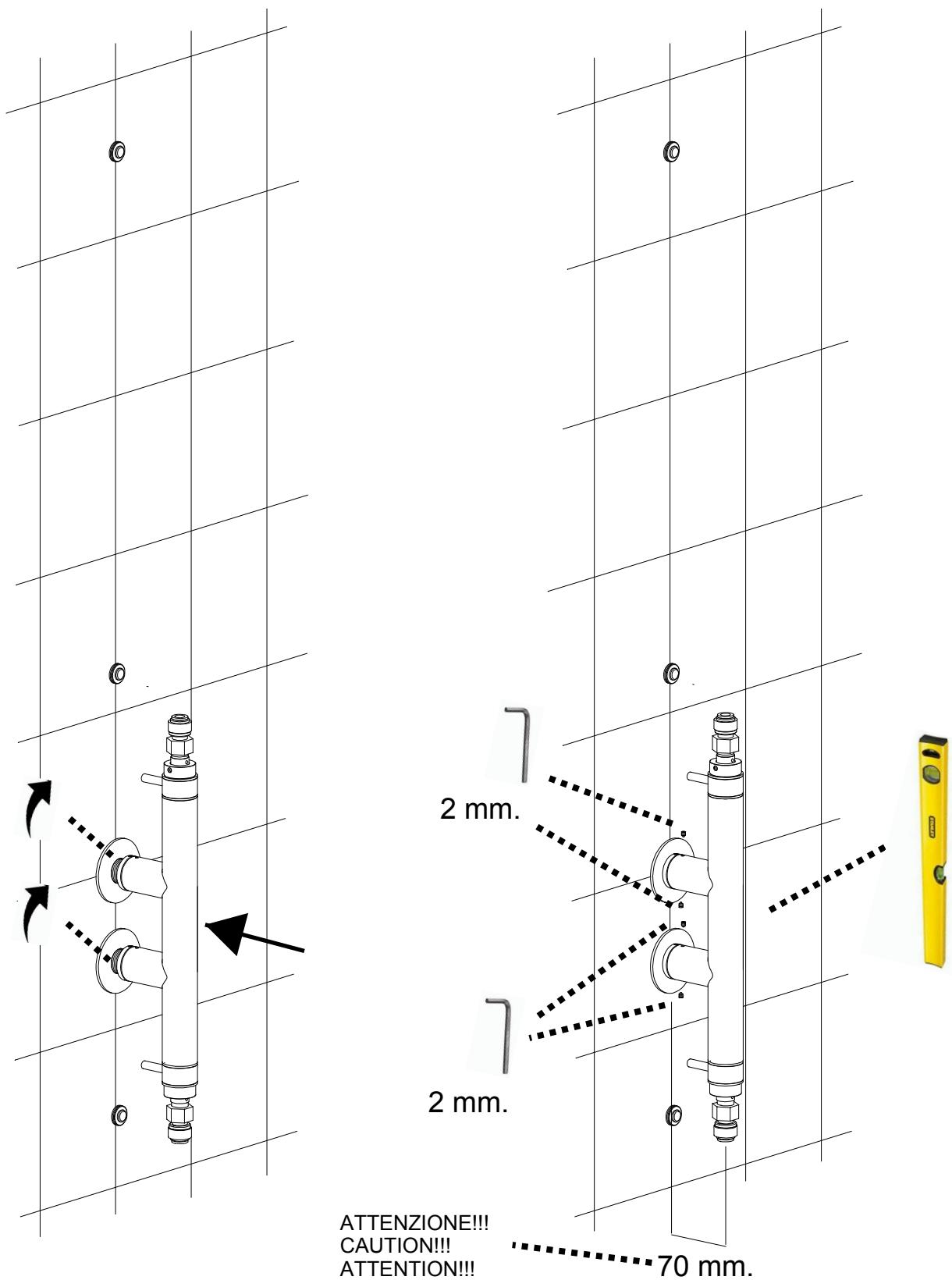
Prima di fissare con i grani il miscelatore assicurarsi che l'interasse dal muro sia 70 mm.
