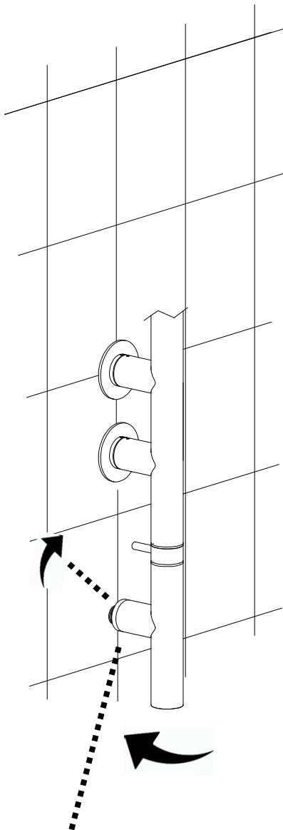
Avvitare i raccordi per fissare il tubo alla parete
